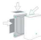
Emplacements disponibles pour adjonctions de cartes électroniques (récepteur radio, module de dialogue centrale d'alarme...).
