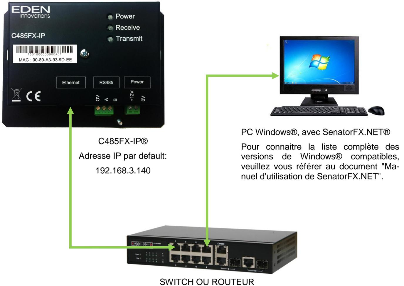
Veuillez utiliser un câble de type RJ45 Cat6 FTP blindé (ou F/UTP blindé).
