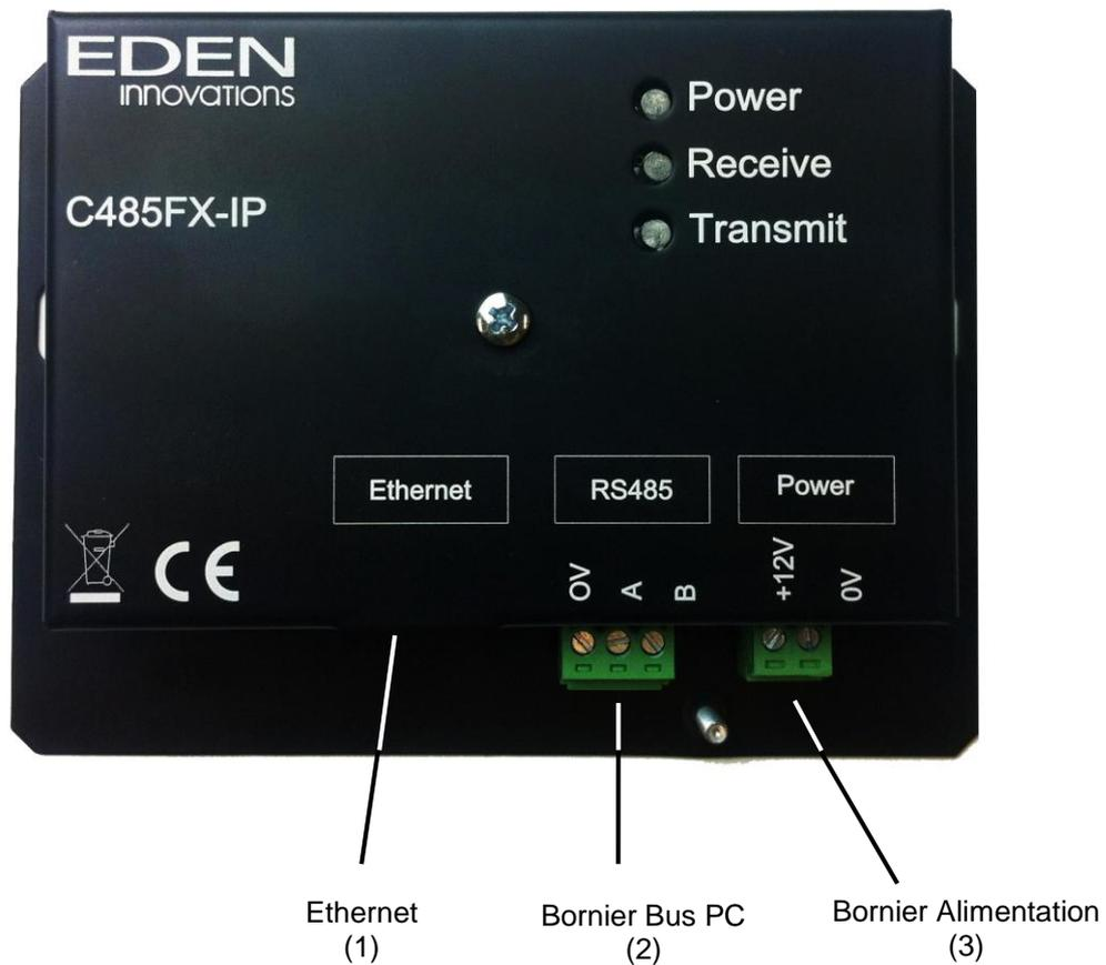
(1) = Connecteur Ethernet, pour raccorder un câble RJ45 au réseau
